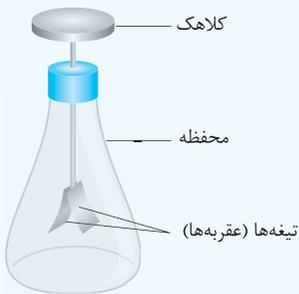
برای این که بدانیم جسمی دارای بار الکتریکی هست یا نه (و گاهی تعیین نوع بار و شدت آن)، از برق نما استفاده می کنیم. برق نما یک میله رسانا است که درون یک محفظه قرار دارد. درون محفظه در انتهای میله، دو تیغه (عقریه) رسانا به آن وصل هستند که می توانند به راحتی حرکت کنند و در حالت عادی به صورت افتاده هستند. در سر دیگر میله در بیرون محفظه، یک کلاهک رسانا قرار دارد.
