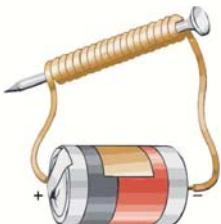
مقداری سیم مسی را حدود ۱۰۰ بار دور یک میخ آهنی بپیچید. سعی کنید از سیمی که روکش نازکی دارد استفاده کنید. در دو انتهای میخ مقداری فضا باقی بگذارید. می‌توانید روی میخ چسب بزنید تا سیم ثابت بماند. دو سر آزاد سیم را به باتری وصل کنید. حالا شما یک آهنربای الکتریکی دارید. به خاطر داشته باشید هرجاکه جریان الکتریسیته وجود داشته باشد، میدان مغناطیسی نیز وجود دارد.
