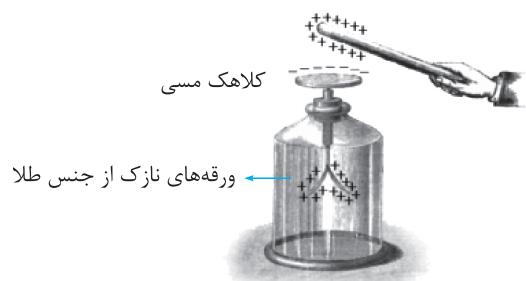
برای تعیین نوع بار یک جسم رسانا باید از یک الکتروسکوپ باردار استفاده کرد. برای باردار کردن الکتروسکوپ مطابق شکل زیر از روش القا استفاده می‌کنیم.
